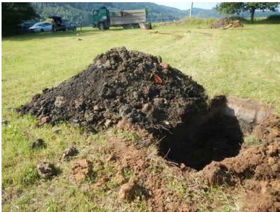
Fotos 3-4: AA „Am Bettacker“, Berghaupten, Schurf BS 2 am 26.06.2019 Auffüllung mit Schwarzdecken, Ziegel, Beton, Holz
