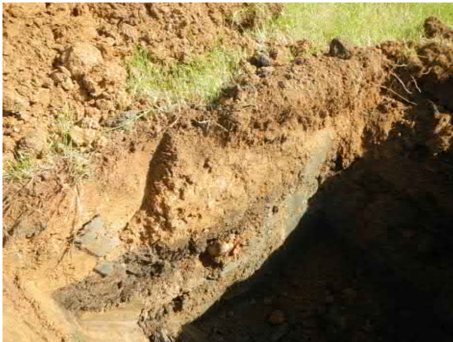
Fotos 5-6: AA „Am Bettacker“, Berghaupten, Schurf BS 3 am 26.06.2019 Auffüllung mit Schwarzdecken, Ziegel, Beton, Baustoffplatten
