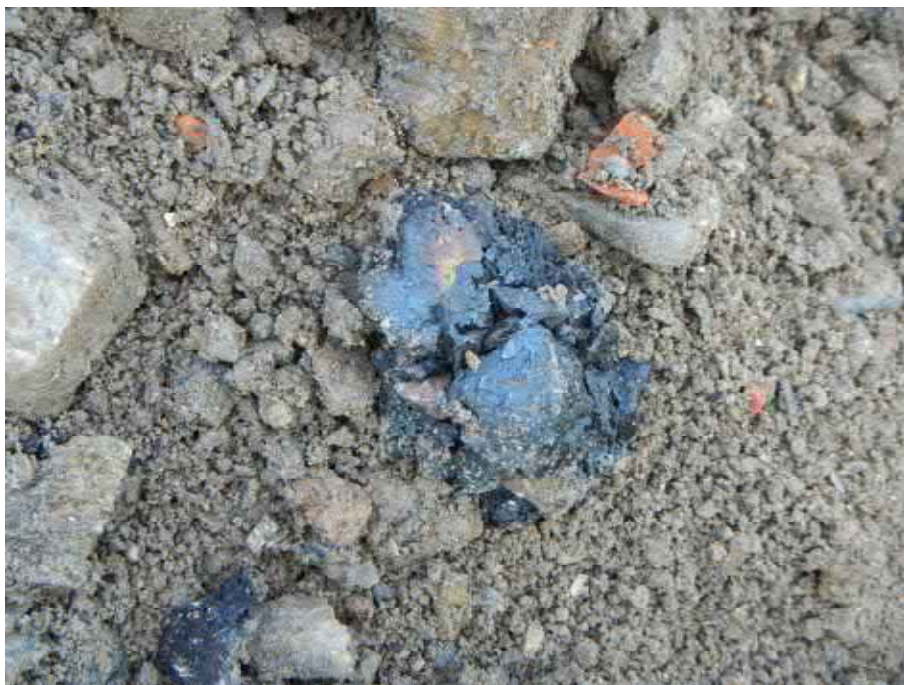
Fotos 13-14: AA „Am Bettacker“, Berghaupten, Schurf BS 7 am 26.06.2019 Auffüllung mit Gneisblöcken und Spritzteer
