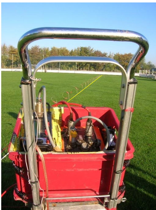
Abbildung A.3: Elektrodenauslage im Gelände und Messapparatur (Multielektroden-Geoelektrik)
