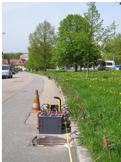
Abbildung A.3: Elektrodenauslage im Gelände und Messapparatur (Multielektroden-Geoelektrik)
